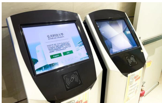
電力儲值系統 (透過悠遊卡餘額儲值用電額度)
